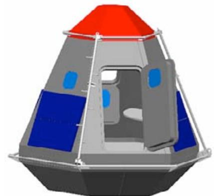
Le Polar Observer, nanti de six hublots, est totalement autonome: un habitacle de 3,7 mètres de haut et de 3,5 de large, de forme conique utilisant de l'énergie propre (panneaux solaires et pile à combustible) et bourré d'appareils de mesure, de sondes et moyens de transmission.
